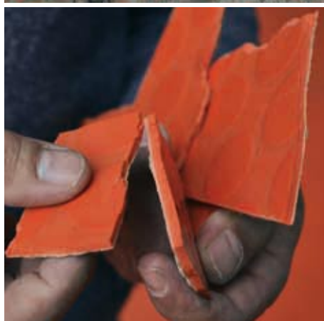
Baustellenbesuch 2: Das Stadttor Düsseldorf ist ein Prestige-Objekt. Hier soll die Empfangsebene erneuert werden. Der alte Nora-Kautschukboden ist in die Jahre gekommen und soll durch einen neuen ersetzt werden. Zehn Bauabschnitte sind hierfür vorgesehen. Das Problem: Der Altbelag lässt sich kaum entfernen. Belag, Klebstoff und Untergrund sind aufgrund von Sonneneinstrahlung eine nahezu unzertrennliche Beziehung eingegangen. Zudem ist der Belag porös und brüchig geworden, was »Stückchen-Arbeit« bei der Abtragung bedeutet.
